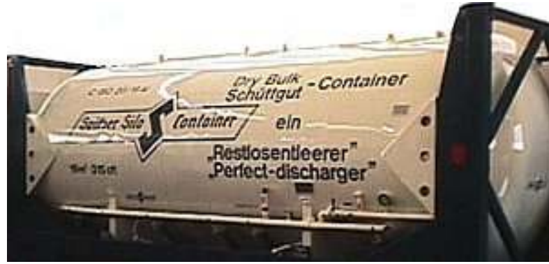
Resim-10/B Hava basıncı ile boşaltılan bulk konteyner
